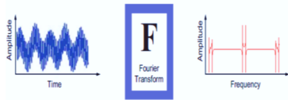
شکل ۲- تبدیل فوریه، یک تکنیک ریاضی (نگاشت) برای تغییر دیدگاه ما از سیگنال بر پایه زمان به سیگنال بر پایه فرکانس
