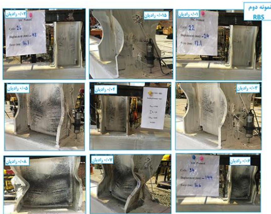
شکل ۲۲- نمونه دوم اتصال RBS تا رسیدن به بیشینه بازه تغییرشکلی ۰/۰۸ رادیان پروتکل بارگذاری SAC
