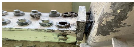
شکل ۱۲- جزئیات تسلیم و گسیختگی نمونه TSTB پس از بارگذاری تا دوران نسبی ۰/۰۸ رادیان
