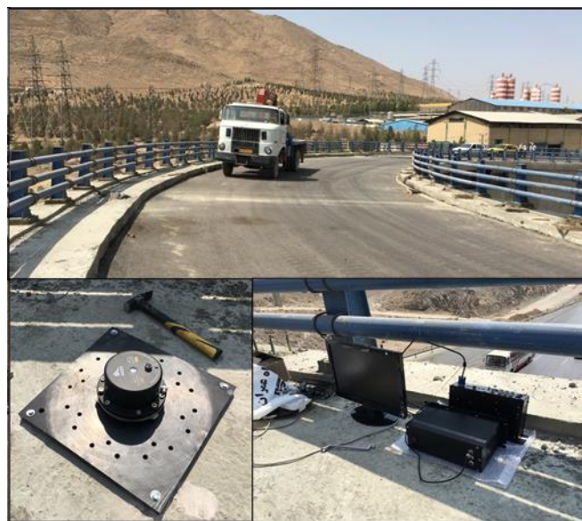
شکل ۶- آزمون میدانی پل با استفاده از شتاب‌سنج
