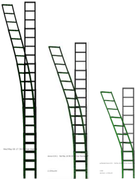
شکل ۱۴- تغییر شکل‌ها بعد از تحلیل قاب‌های خمشی
