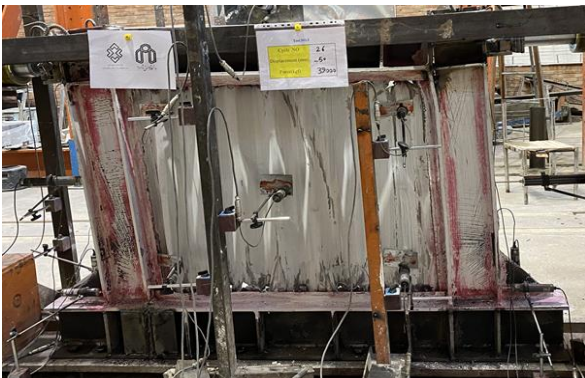
شکل ۱۷- شکست جوش سخت‌کننده زیر ستون در جابجایی ۰/۲۹۰٪
