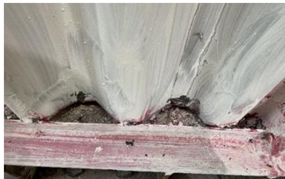
شکل ۱۸- روند تغییر شکل در پایان بارگذاری تا جابجایی ۰/۴۵٪
