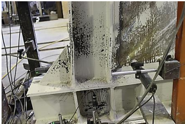
شکل ۱۳- پارگی بال ستون در مجاورت لبه فوقانی ورق مثلی تقویت اتصال در جابجایی ۶/۶۱٪
