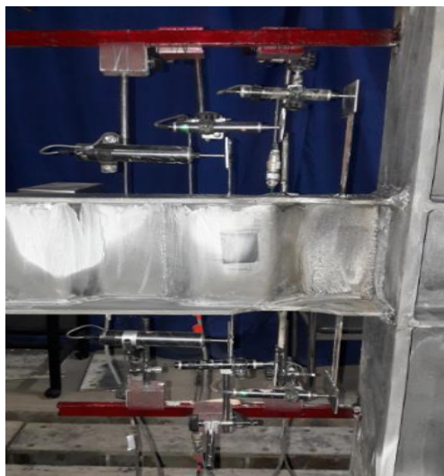
شکل ۷- موقعیت نصب جابه‌جایی سنج‌های (LVDT) نمونه‌های آزمایشی
