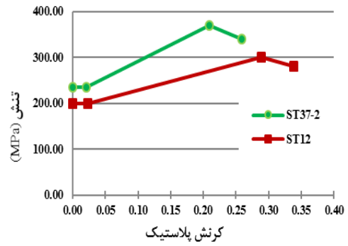
شکل ۹- نمودار تنش-گرنش پلاستیک مصالح ST12 و ST37
