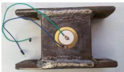
شکل ۲- پروفیل فولادی و محل اتصال حسگر پیزوالکتریک
