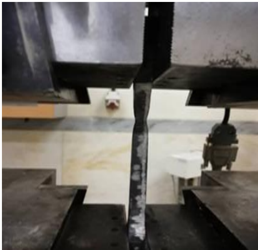
شکل ۶- تست کشش جهت تعیین مشخصات فولاد
