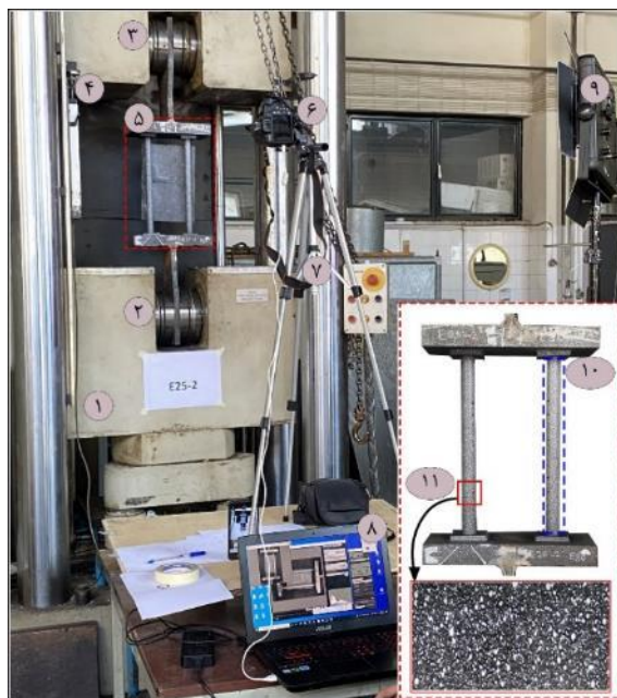
شکل ۱۴- محیط آزمایشگاه- (۱) دستگاه کشش- (۲) فک ثابت (۳) فک متحرک- (۴) تغییر مکان سنج خطی- (۵) نمونه آزمایشگاهی (۶) دوربین عکس برداری- (۷) سه پایه- (۸) لپ‌تاپ- (۹) نورپردازی (۱۰) سطح مورد بررسی- (۱۱) الگوی رنگی سیاه و سفید
